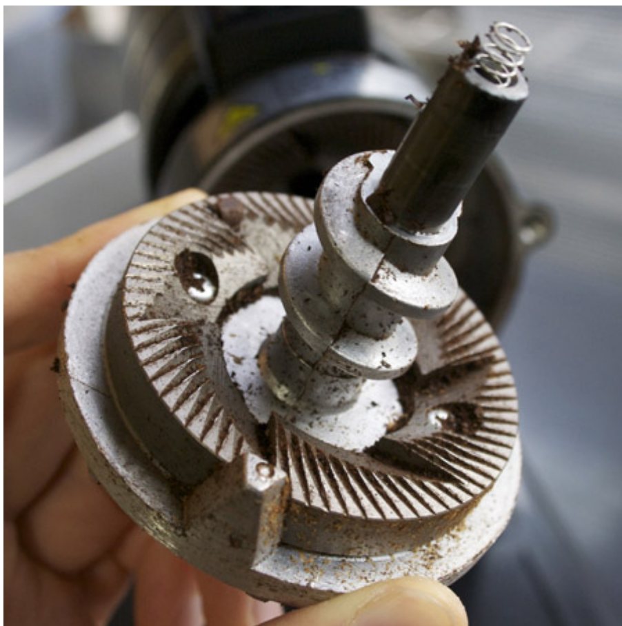
カリタ製「ナイスカットミル」グラインダー式 フラット歯
